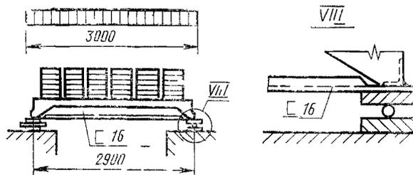
План расположения опор при испытании
